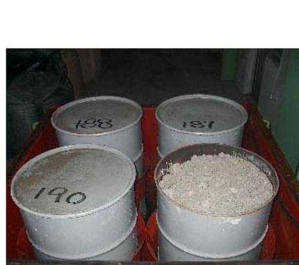
図-2 実証試験に使用した PCB 汚染土壌
