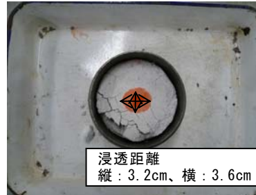
写真1 境界面(遮水シート)
