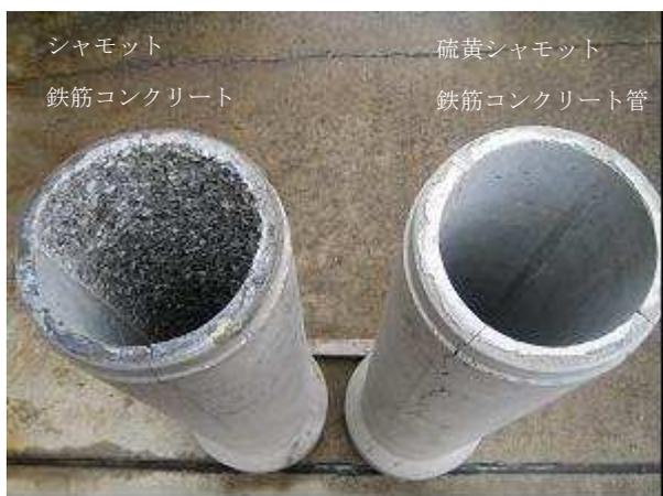
写真-4 30日間10%硫酸水溶液に暴露した状態
