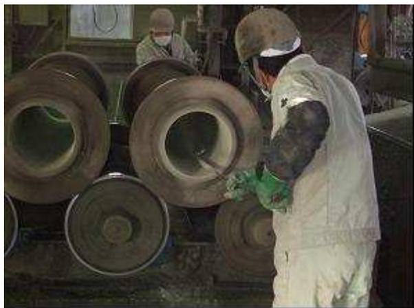
写真-3 硫黄シャモットコンクリート管成形状況
