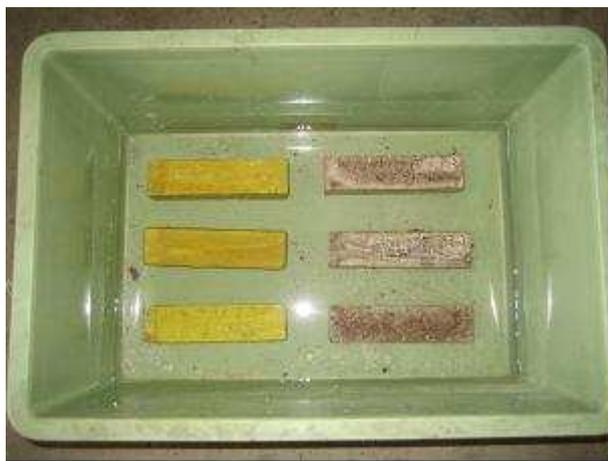
写真-2 10%硫酸水溶液に暴露した状態
