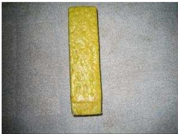
写真-1 硫黄シャモットポリマーに浸漬した供試体
