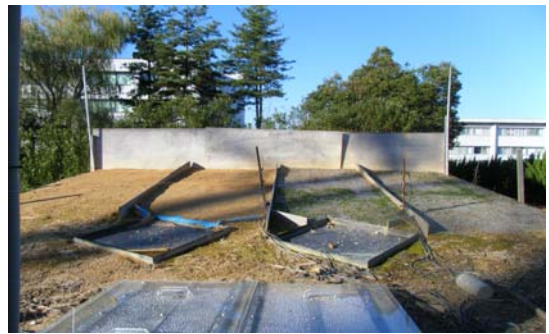
図 1 屋外実験斜面（右半分に植生シートを敷設）
