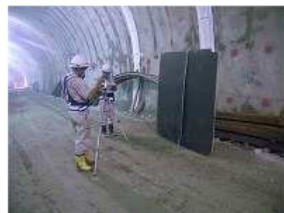
写真-3 デジタルカメラを用いた粉じん濃度計測状況
