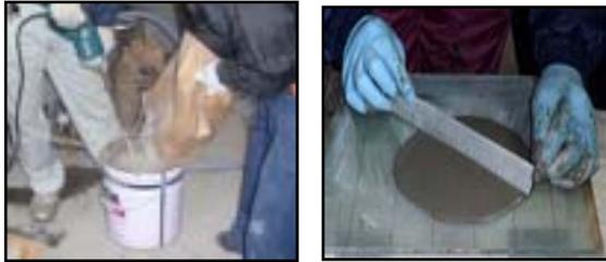
写-1 充填材の練り混ぜ 写-2 静置フロー値測定
