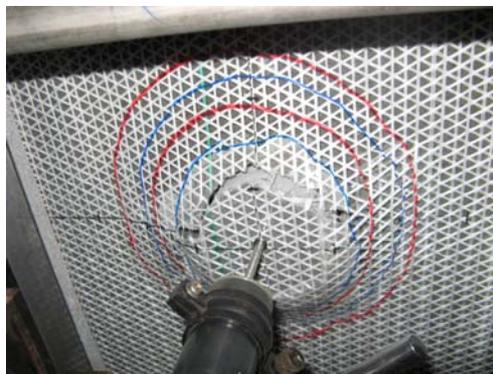
写真-3 -10°Cの場合の剥離、破断状況
