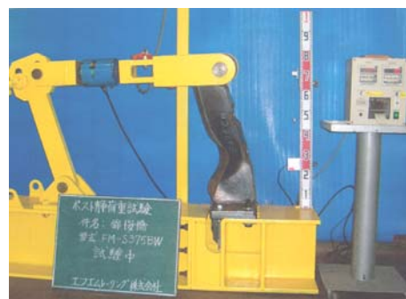
写真-3 支柱静的載荷試験
