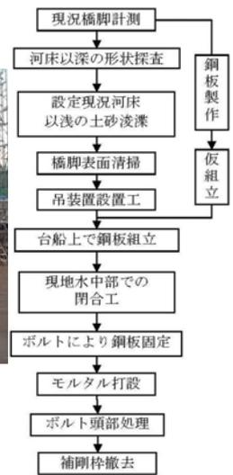
図-3 施工フロー図
