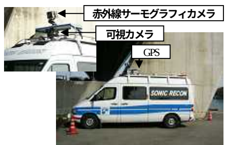
図3. 舗装点検車(赤外線サーモグラフィカメラ・可視カメラ・GPS装備)
