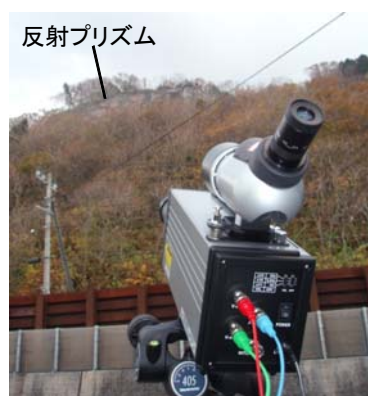
図5 岩盤斜面の現地計測風景
