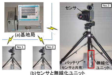
図10 岩盤斜面計測システムプロトタイプ
