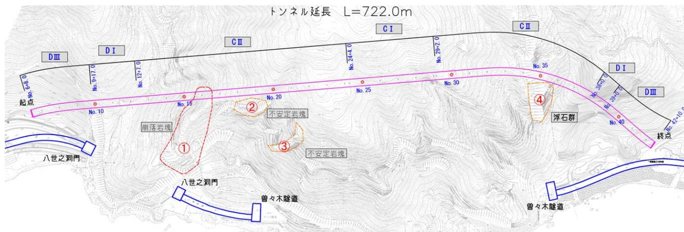
図－1 崩落岩塊、不安定岩塊と新設トンネル施工位置平面図
