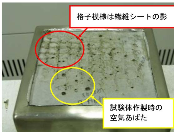
写真－1 発熱性試験後の試験体状況
