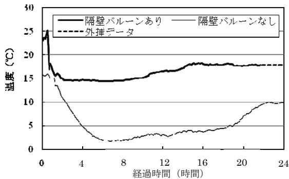
図-5 管理供試体の温度測定結果
