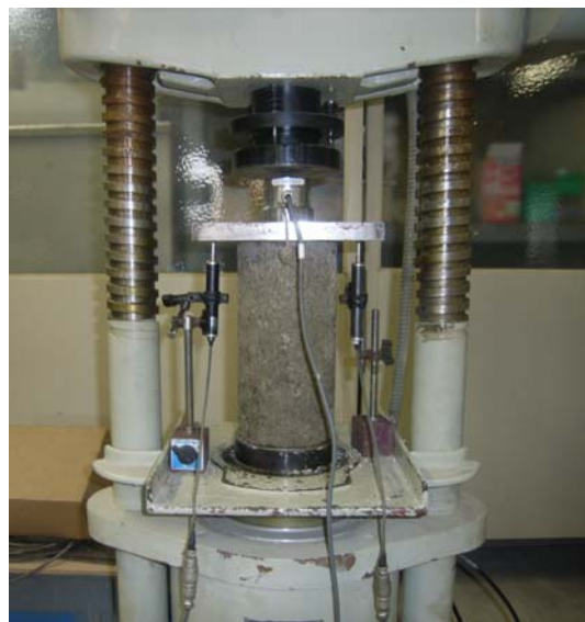
写真 2 圧縮強度および「ひずみ」測定状況
