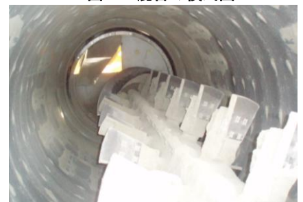
写真-2 混合装置内部
