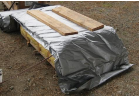
写真-2.1 供試体養生状況
