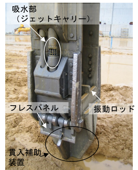
写真-2 振動ロッドの先端部 (貫入補助装置付)
