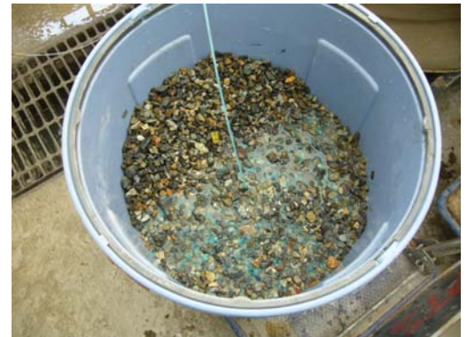
図-5 薬液の逸走状況（無対策）
