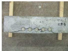
写真 4 ひび割れ発生状況
