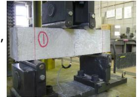
写真-6 曲げ靱性試験状況
