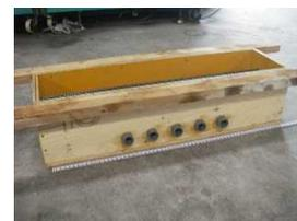
写真 3 供試体型枠
