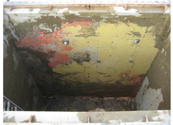
写真-1 土槽北面の界面注入状況
