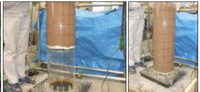
写真 3 左:中型水槽模型 中:鋼管を上下させながら充填している状況 右:充填完了
