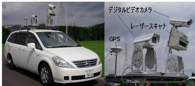
図-1 LANDMark システムの車載の様子
