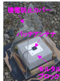
図2 GPS アンテナ設置方法
