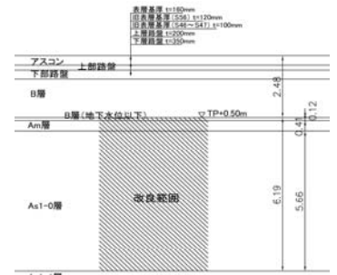
図-8 滑走路の対策断面
