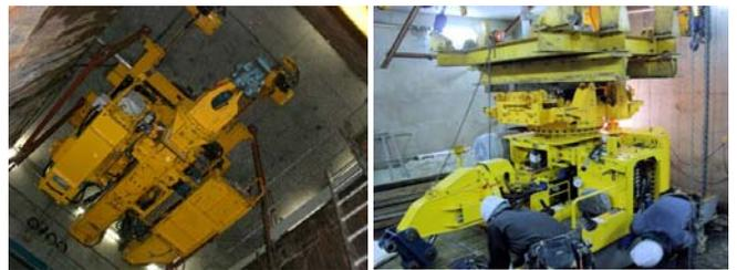
写真-1 掘削機回収・点検状況
