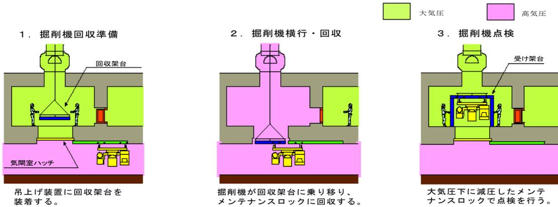
図-4 掘削機回収および点検作業の手順
