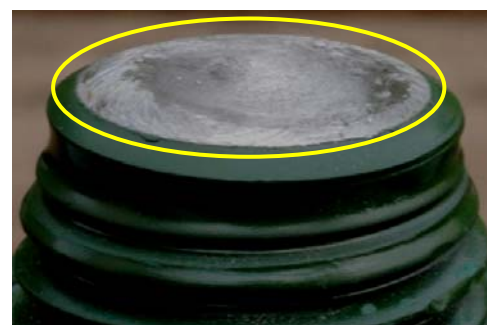
写真-2 仕上げ後のピンテール破断跡
