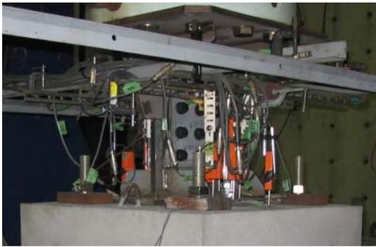
写真-1 引き抜き試験状況
