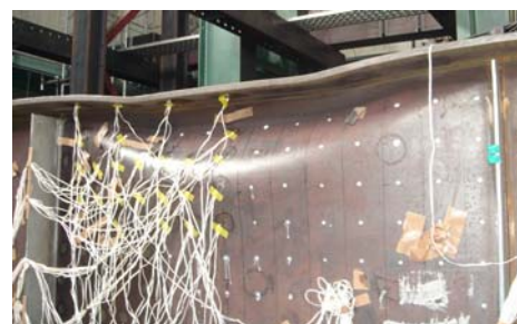
写真3 「補強なし」の最大耐力以降の過大変形状況
