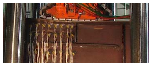
写真2 「水平プレート+鉛直プレート」の最大耐力時の変形状況
