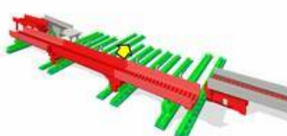
(ステップ②) 新設高架橋をジャッキアップ 水平移動 (約 13m)
