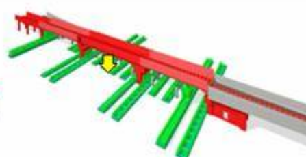
(ステップ③) 所定位置まで移動後ジャッキダウン 柱接合。
