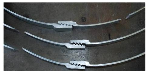
写真3 試験後の試験体例(孔無/ボルト無)
