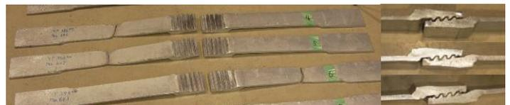
写真2 引張試験後の試験体例(りん酸塩処理)
