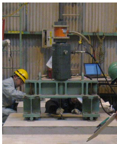
写真－２．引抜き試験状況
