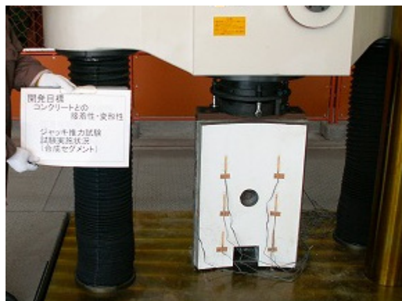
写真-4 ジャッキ推力試験による 基準許容耐力載荷時の状況
