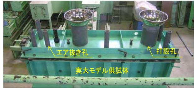
図-7 高流動コンクリートの施工実験概要
