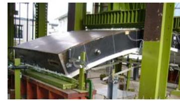
図-3 線荷重試験概要
