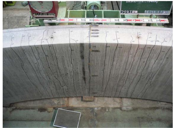
写真-3 荷重 P=300[kN] 時のひび割れ
