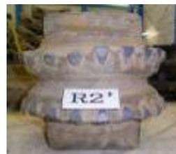
写真-4 超硬チップ変形
