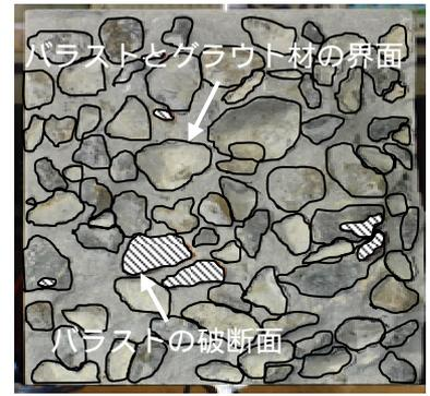
図 4 曲げ破壊面
