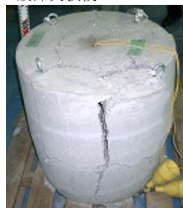
試験体 A_特殊液量 10cc 破砕実験後
