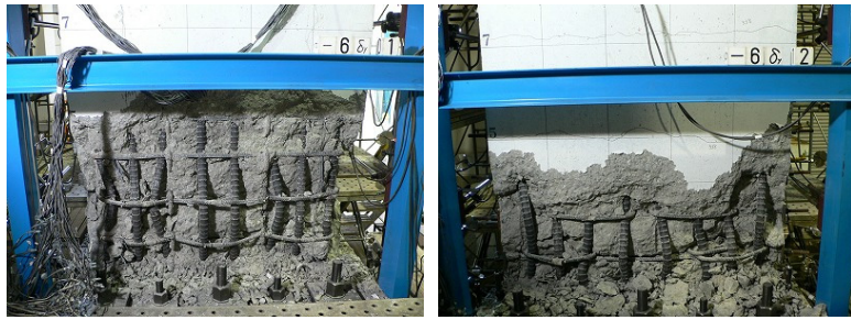
写真-1 試験体破壊状況 (左:試験体 No.1, 右:試験体 No.2)
