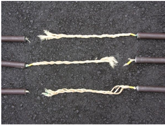
図2 供試体 1～3 の破断状況
