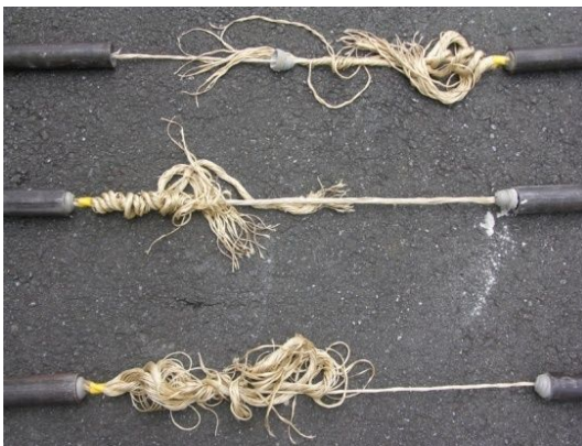
図4 供試体 7～9 の破断状況
