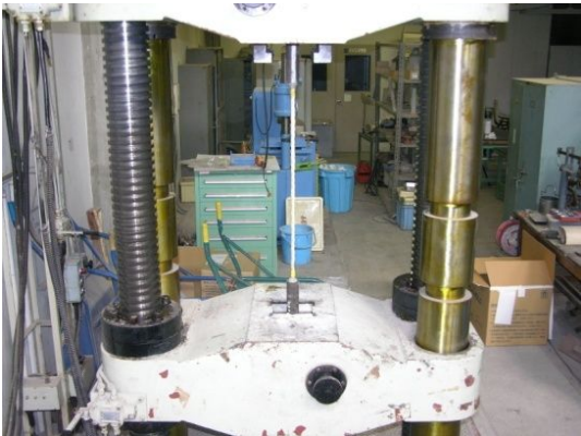
図1 引張試験状況
