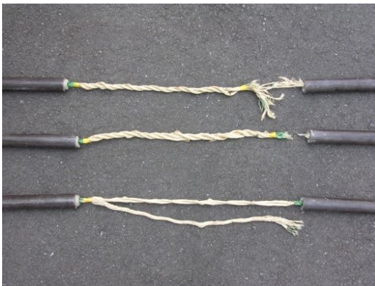
図3 供試体 4～6 の破断状況
