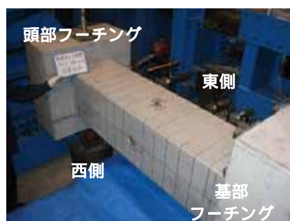
図 - 1 供試体設置状況
