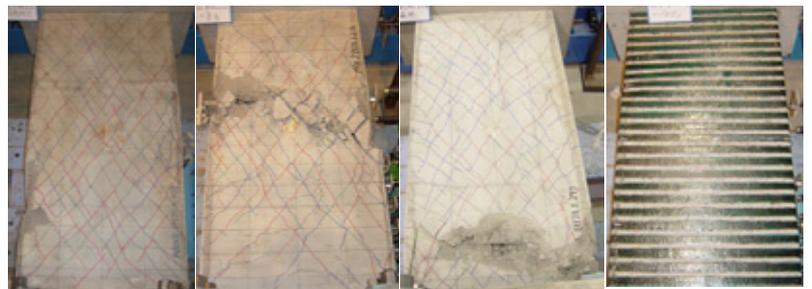
写真-1 最終的な破壊性状 (左から、供試体 No. 1, No. 2, No. 3, No. 4)
