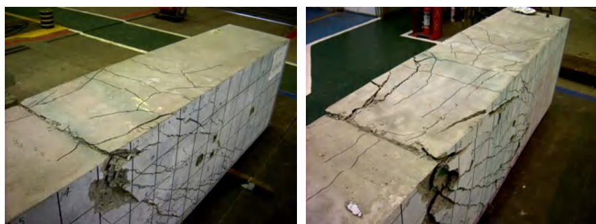
写真1 最終破壊状況
