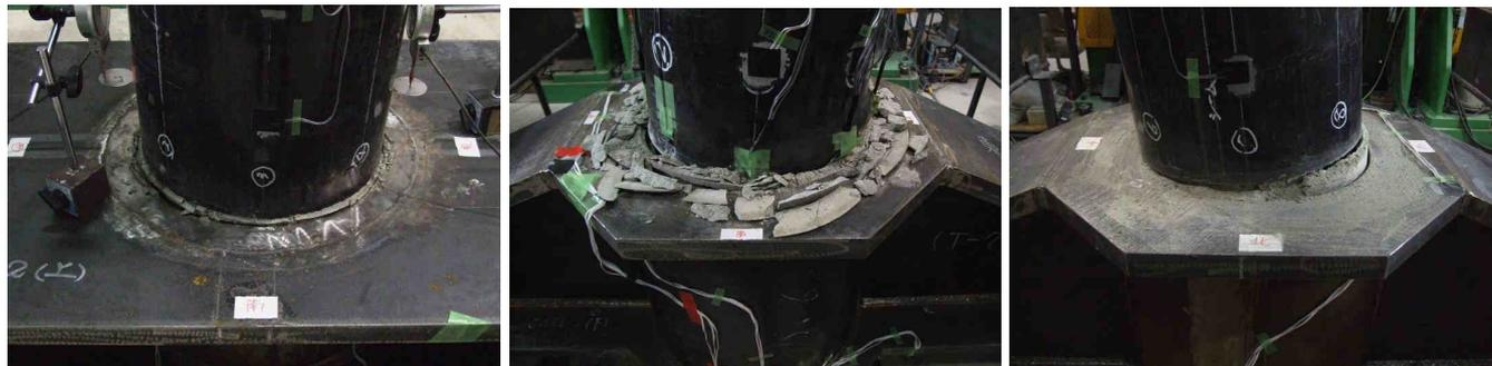
写真1 T-6(3 y:部材角 1/20) 写真2 T-7(4 y:部材角 1/10) 写真3 T-8(7 y:部材角 1/8)
