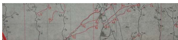
前載荷曲げ 80.5%→ねじり残存耐力:70%
