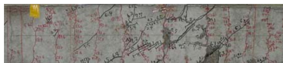
前載荷曲げ 80.4%→ねじり残存耐力:70%
