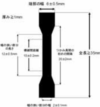
図 1 5B 型試験片形状
