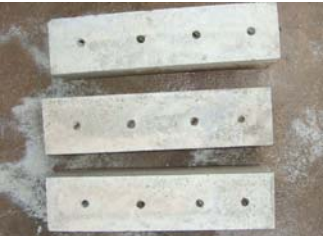
写真-7 新規モルタルの稚貝の埋め込み
