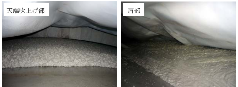
写真-2 コンクリートの流動状況(通常配合)
