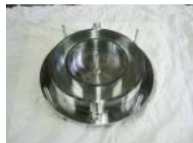
図一 リング型拘束ひび割れ抵抗性試験用型枠
